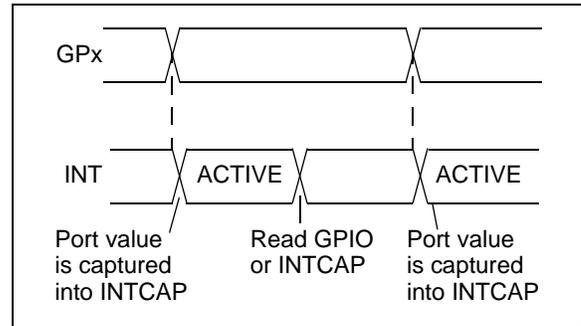
**FIGURE 3-9: INTERRUPT-ON-CHANGE FROM REGISTER DEFAULT**
